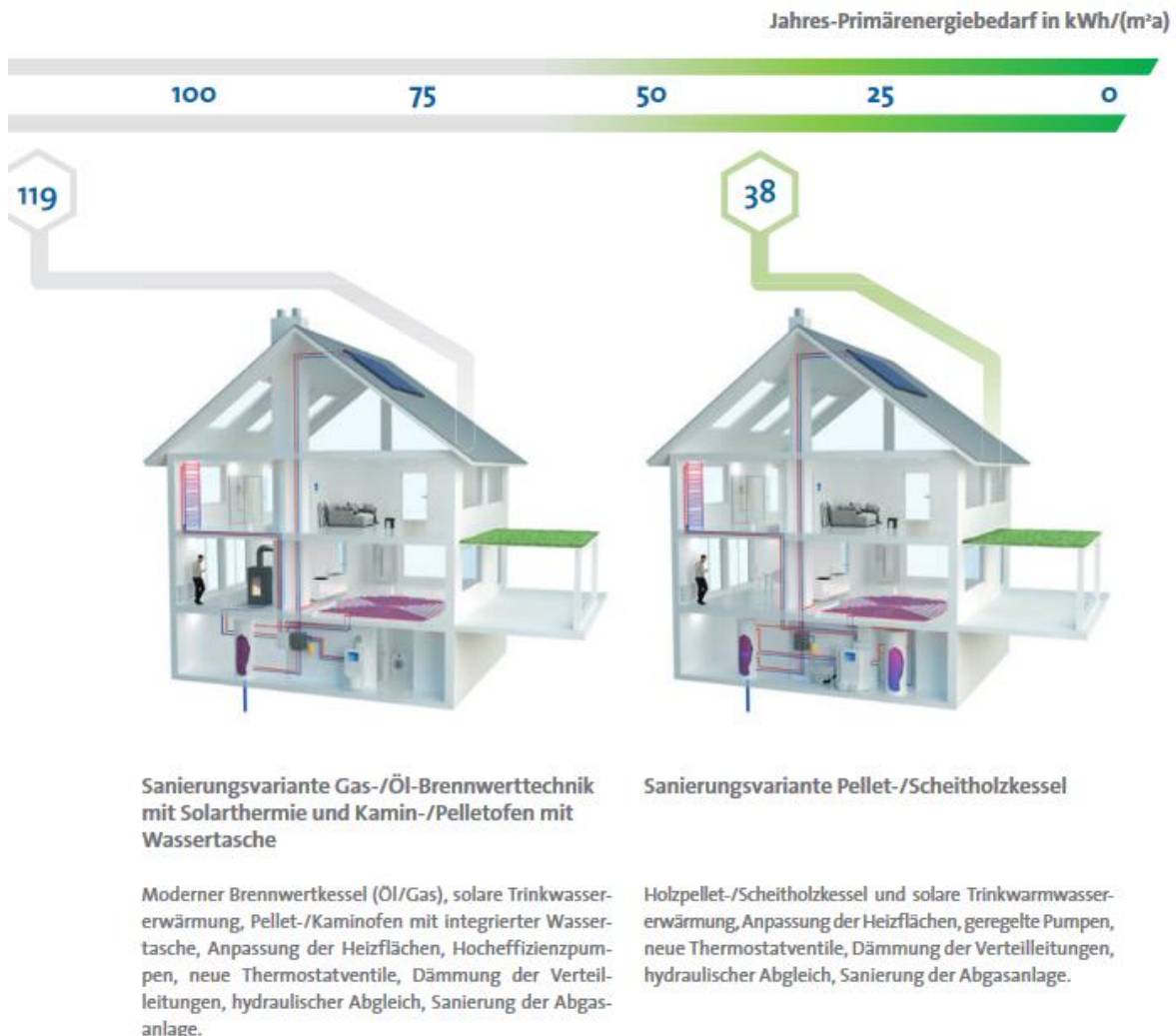
Abbildung 29 Einsparpotenziale durch Kombination effizienter Anlagentechnik (BDH 2021)
